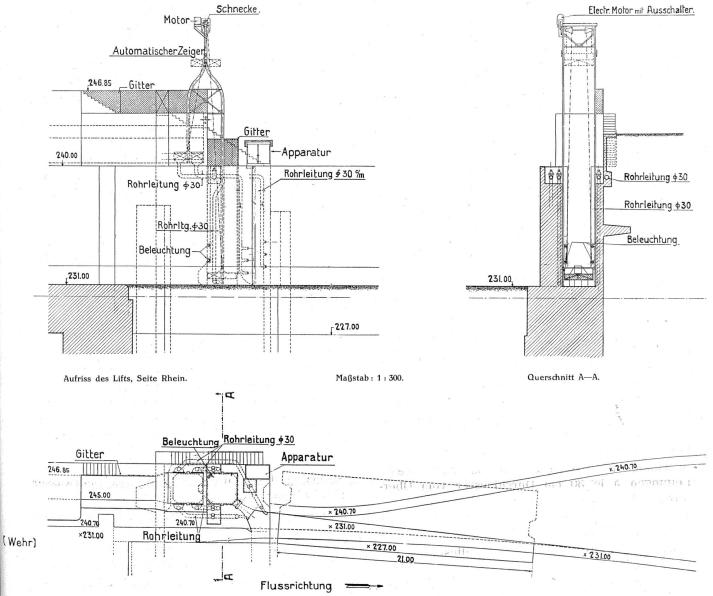
Abb. 2. Automatischer Fisch-Lift, System Gutzwiller, am linken Ufer des Stauwehrs des Kraftwerkes Kembs am Rhein. Maßstab: 1:300.
