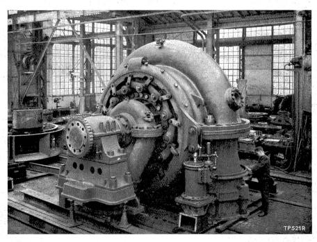
Abb. 1. Ansicht der Speicherpumpe für das Schwarzenbachwerk.
