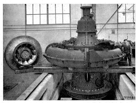
Abb. 3. Speicherpumpe für das Leitzachwerk.
