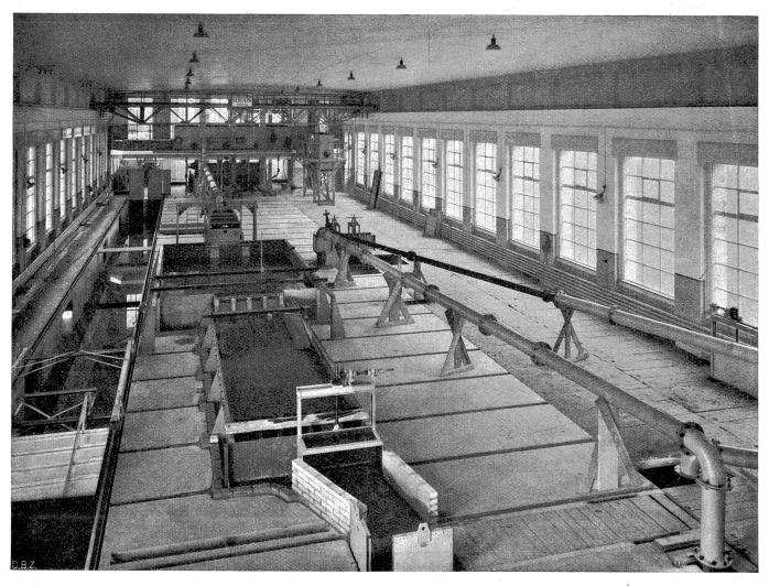
Abb. 1. Großer Versuchsraum. Links Meßkanal mit Schirm, Mitte Modell für das Limmatkraftwerk Wettingen, rechts Leitung für die Eichung des Meßüberfalles der Demonstrationsrinne und Leitung für die Eichung von Meßdüsen.
