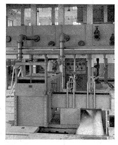
Acb. 11. Mitteldruck-Behälter; im Vordergrund Eichung eines Ueberfall-Meßkastens.
