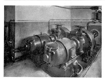
Abb. 6. Antriebsmotoren der zur Speisung des großen Versuchskanals dienenden Propeller-Pumpen für max. 2 m³/sec mit den ferngesteuerten Spezial-Wechselgetrieben.
