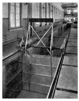
Abb. 5. Großer Versuchskanal mit Beobachtungsfenstern und Meß-Schirm.
