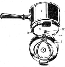
Abb. 2. Maxim-Schnellkocher. Unterteil losgelöst.
