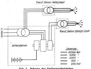
Abb. 2. Schema des Umformerbetriebes.
