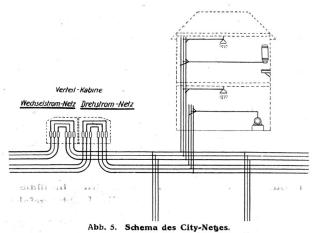
kannt und bewährt. Das System gestattet die Verteilung mit höherer und die Speisung der Verbraucher mit niederer Spannung. Die Verluste werden auf ein Minimum reduziert, ohne daß die Gebrauchsspannung über ein bestimmtes Maß erhöht zu werden braucht. Die hohe Verteilspannung mit niederer Gebrauchsspannung und der Wegfall der teuren Umformeranlagen lassen dieses System für die Versorgung der in Zürich sehr weitläufig überbauten Wohnquartiere am geeignetsten erscheinen.
