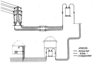
Abb. 3. Schema des Transformatorenbetriebes.
