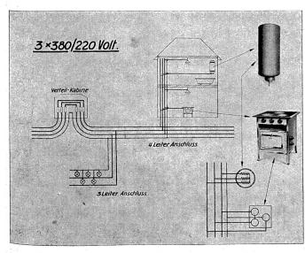
Abb. 4. Schema des Einheitsnetzes
