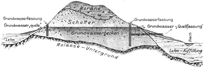
Abb. 1. Grundwasserbecken. Ueberlaufquellen = Grundwasser.
