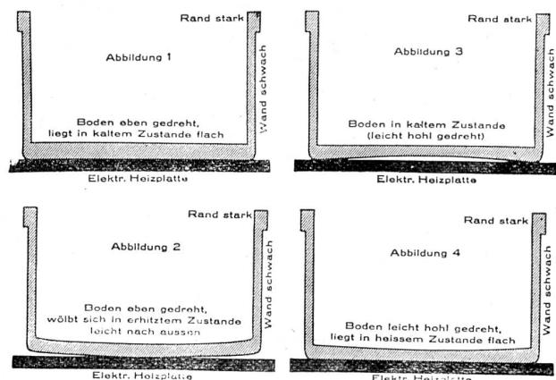
des S. E. V. hat bei der Prüfung das Geschirr hundertmal auf 200 Grad erhitzt und jedesmal mit einem Liter Wasser von zirka 10 Grad Celsius abgeschreckt, ohne ein Verziehen beobachten zu können. Das Geschirr besitzt hohe mechanische Festigkeit und ist mit einem gegen Stoß, Hitze und Speisesäuren unempfindlichen Emaille überzogen. Es können darin alle Speisen gekocht; es kann auch zum Braten verwendet werden.
