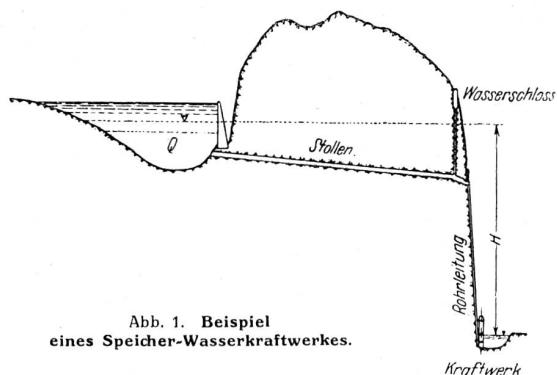
Wenn in einem Staubecken eine verwertbare Wassermenge  $Q$  in  $\text{m}^3$  bei einem mittleren Gefälle  $H$  in  $\text{m}$  (Abb. 1) zur Verfügung steht, so ist (weil  $366,000 \text{ mkg} = 1 \text{ kWh}$  sind) die aufgespeicherte Arbeitsmenge:
