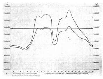
Abb. 6. Verlauf der wirklichen Geesamtbelastungen der größeren schweizerischen Elektrizitätswerke am 17. November 1926.
