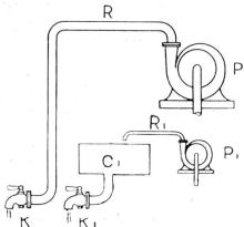
Abb. 7. Bildlicher Vergleich zwischen Speicherherd und Effektherd.
