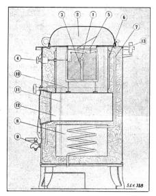
Abb. 13. Schnitt durch den Seves-Speicherherd
