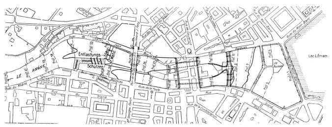
Fig. 3. Situationsplan der Rhonekorrektion in Genf gemäß Projekt 2 c.
