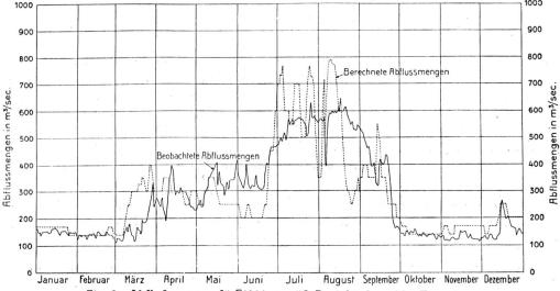
Fig. 2. Abflußmengen für 1914 gemäß Projekt der eidg. Experten.
