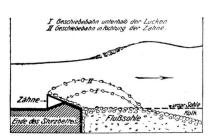
Abb. 4. Wandern des Geschiebes an einer Zahnschwelle, festgestellt durch Zeitlupenaufnahme.
