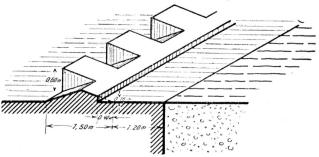
Abb. 7. Geplante Anordnung der Zahnschwelle bei dem Wehr Ryburg-Schwörstadt.
