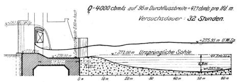
Abb. 8. Kolkbildung bei einem Flußbett aus Kies von 6-12 mm Korngröße bei ebenem Sturzboden mit Zahnschwelle nach einer Versuchsdauer von 32 Stunden.
