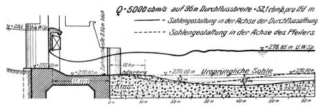
Abb. 3. Kolkbildung bei einem Flußbett aus Kies von 6-12 mm Korngröße bei ebenem Sturzboden mit Zahnschwelle nach einer Versuchsdauer von 1 Stunde.
