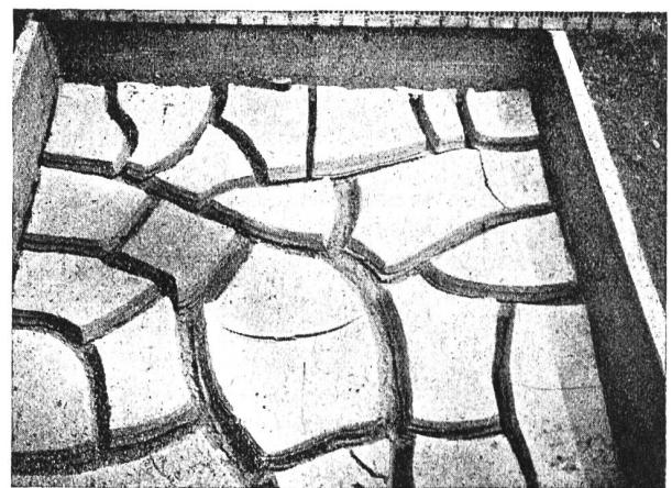
Abb. 12. Betontrog. Vollständig ausgetrockneter Lehm.
