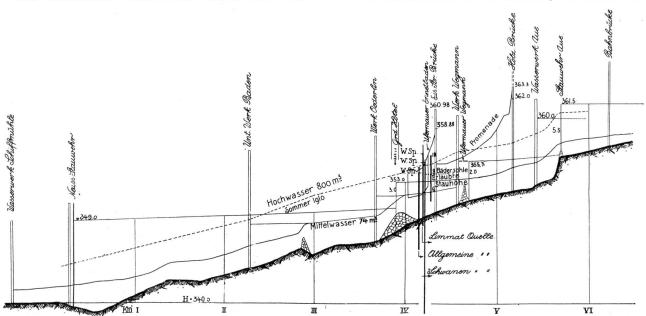
Abb. 5. Längenprofil der Anlagen zur Schiffbarmachung der Limmat in die Stadt Baden. Maßstab: Längen 1:4000, Höhen 1:400
