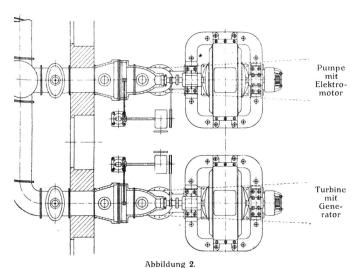
Maschinenanlage zu einem Akkumulierungswerke. = 150 m. Turbine:  $\Omega=3,92$  m³/sek. N = 6300 PS. n = 1000 Umdr./min. 1:150.
