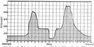
Abbildung 1. Belastungskurve eines Elektrizitätswerkes im Winter.
