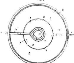
die schräge Fläche die Wand c überläuft, wodurch die Strömungsgeschwindigkeit im Zulaufgerinne sich in erster Linie verringert und ferner auch mehr nach unten verlegt wird; dadurch ist den Schwimmstoffen Gelegenheit gegeben, sich an der Oberfläche des Gerinnwasserspiegels anzusammeln, um dann abgeschröpft zu werden.
