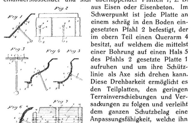
Diese Drehbarkeit ermöglicht es den Teilplatten, den geringen Terrainverschiebungen und Versenkungen zu folgen und verleiht dem ganzen Schutzbelag eine Anpassungsfähigkeit, welche ihn bei gewöhnlichen Böschungsbewegungen vor Beschädigung bewahrt. Ein am obigen Ende des Pfahls 2 angebrachter Kopf 6 hält die Teilplatte am Pfahl fest, hindert aber deren Drehung um die genannte Axe nicht.
