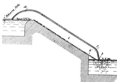
keitsstrahl, wenn er nach Abspringen von der Kante *2'* des Knie *2*, Luft mitreissend, im spitzen Winkel zur Flüssigkeitsoberfläche in das Unterwasser eindringt, ein intensives Ausstossen der aus dem Saugrohr mitgerissenen Luft ins Freie bewirkt.
