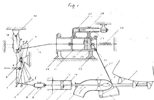
12 befindliche Öl mit wenig Widerstand unter der Klappe 14 hinweg auf die rechte Kolbenseite hinüberfließen kann. Bei der Bewegung des Kolbens 12 von links nach rechts jedoch schliesst die Klappe 14 die Bohrung teilweise oder vollständig.
