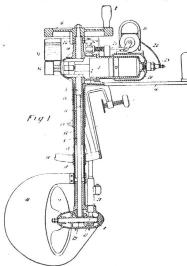
Das Steuerrohr 13 ist mit dem Gehäuse 8 festverbunden und trägt am oberen Teil eine geschlitzte Hülse 14, welche durch Anziehen einer Schraube 15 auf dem Rohr 13 festgeklemmt werden kann. Fest vereinigt mit der Hülse 14 ist die Steuerpinne 16, durch welche das Steuerrohr 13 zusammen mit dem Gehäuse 8 und dem Propeller 9 gedreht werden kann.
