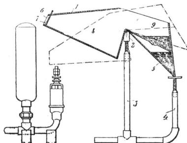
Wasser entnommen wurde, ist der Zufluss zum Anlassbehälter unterbrochen. Bleibt der Widder stehen, so steigt das Wasser im Reservoir und fliesst schliesslich wieder dem Anlassbehälter zu, worauf derselbe wieder in Tätigkeit tritt, und somit dem Stossventil sofort wieder der notwendige Impuls zur Weiterarbeit des Widder gegeben wird.
