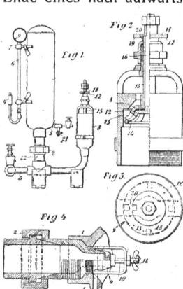
Sowohl das Triebrohr 3, als auch das zum Stossventil führende Zuleitungsrohr ist im Kreisbogen um 90° abgebogen, und zwar in zwei miteinander einen Winkel einschliessenden Ebenen.
