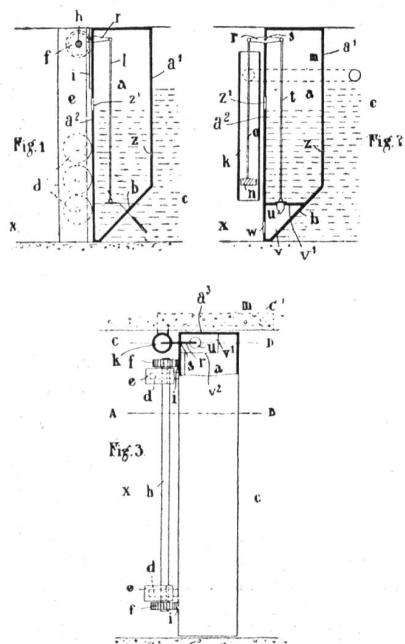
Wasserdruck in die Öffnung der Wand  $v^1$  gedrückt und verhindert daher das Eindringen von Wasser in die Kammer  $v$ . Steigt nun der Oberwasserspiegel um einen den Abstand zwischen seiner Normalhöhe und dem tiefsten Punkt der
