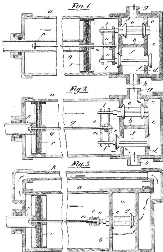
in den vordern Raum des Arbeitszylinders  $a$  ein und drückt hiebei den Kolben  $r$  in der Pfeilrichtung Fig. 1 nach hinten. Hat derselbe seinen Weg nahezu beendet, so zieht er vermittelst der Stange  $q$  die beiden Doppelventile  $e$  und  $f$  nach
