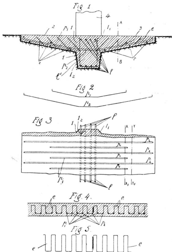
de l'âme et dont l'une au moins diminue d'épaisseur de celle-ci vers son extrémité libre et renferme des armatures métalliques transversales dont la section totale décroît de cette âme vers l'extrémité libre de l'aile, en vue que cette dernière ait une disposition se rapprochant de celle d'un solide d'égale résistance.
