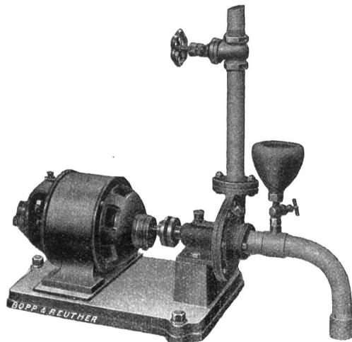
Kühlwasserbeförderung für Gas- und Benzinmotoren usw. verwendbar. Der Flügel ist einseitig saugend ausgeführt. Das Gehäuse ist vertikal geteilt, die Stahlwelle ist in dem mit Rotgussbüchsen versehenen und an das Gehäuse angegossene Lager gelagert. Der Druckstutzen ist vertikal nach oben gerichtet. Die Leistungsfähigkeiten der Pumpen bewegen sich je nach der Grösse bei normaler Wassermenge zwischen 18 und 222 Liter und bei maximaler Wassermenge zwischen 35 und 362 Liter Wasser in der Minute.
