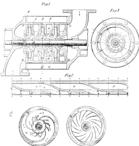
letztere auf einem die Anzahl der Leitkanäle ungefähr reziproken Bruchteil seines Umfanges (also zum Beispiel bei drei Kanälen ein Drittel des Umfanges).
