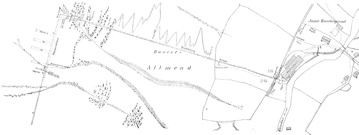
Situationsplan von Wasserschloss, Druckleitung und Zentrale. Maßstab: 1:3500.
