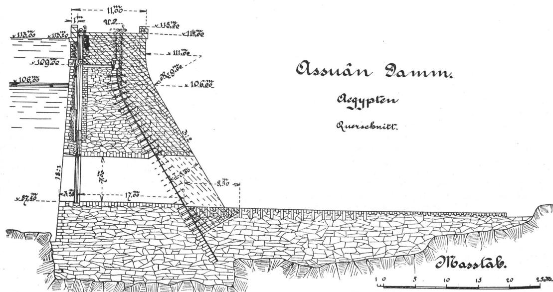
files dagegen die durch eine auf Höhencote 114 liegende Fahrstrasse begrenzte Erhöhung und Verstärkung des Staumauerquerschnittes dar.
