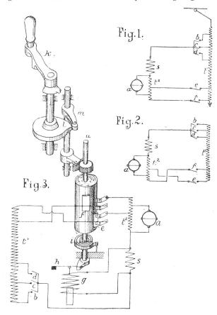
Erregertransformator, gekennzeichnet durch derart angeordnete Schaltorgane für die Umschaltung von der Anlaufzur Laufschaltung, dass durch dieselbe Schaltstelle gleichzeitig die Sekundärspannung des Netztransformators und das Übersetzungsverhältnis des Erregertransformators geändert wird.
