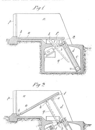
Nell' annesso disegno, che serve ad illustrare, a titolo d'esempio, una forma d'esecuzione dell' invenzione, la figura 1 mostra una paratoia della diga nella posizione abbassata sul letto del corso d'acqua, e la figura 2 la stessa paratoia nella posizione elevata. Le figure sono schematiche ed in scala arbitraria.
