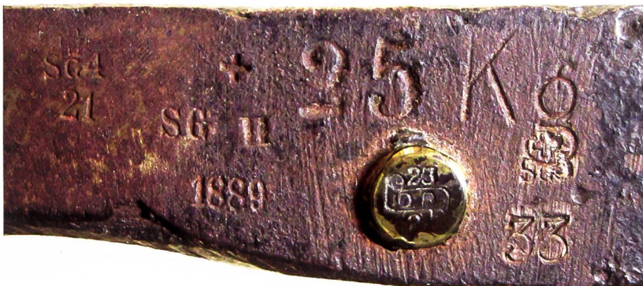
Waagen-Arm mit Detailaufnahme der Punzen.
