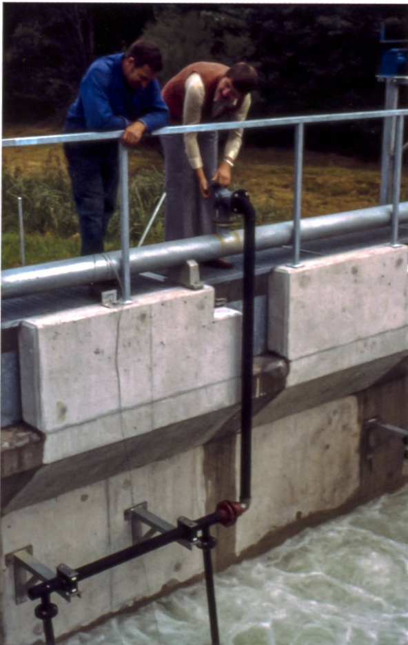
Belüftungstest der biologischen Stufe der ARA, 1978.
