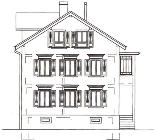
Strassenansicht eines Hauses mit ausgeprägten Fensterbedachungen, die wesentlich zum wohlproportionierten Fassadenbild beitragen.
