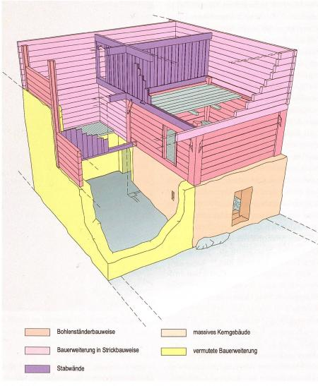
Abb. 17. Isometrie des Holzbaukomplexes im Zustand 2016. Die Farben entsprechen denjenigen der Grundrisse. Plan Kunstdenkmälerinventarisation 2016, Kantonale Denkmalpflege St. Gallen
