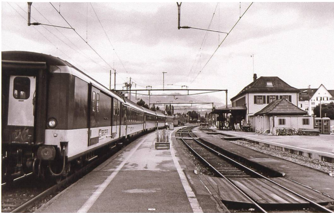
Der «Rheintal-Express» wurde im Jahr 2000 aus modernen Einheitswagen Typ IV und Zusatzwagen Typ II formiert. In Heerbrugg blieben die Gleis- und Fahrleitungsanlagen noch weitgehend auf dem Stand der Elektrifikation von 1928. Foto Anton Heer, 29. Juli 2000
