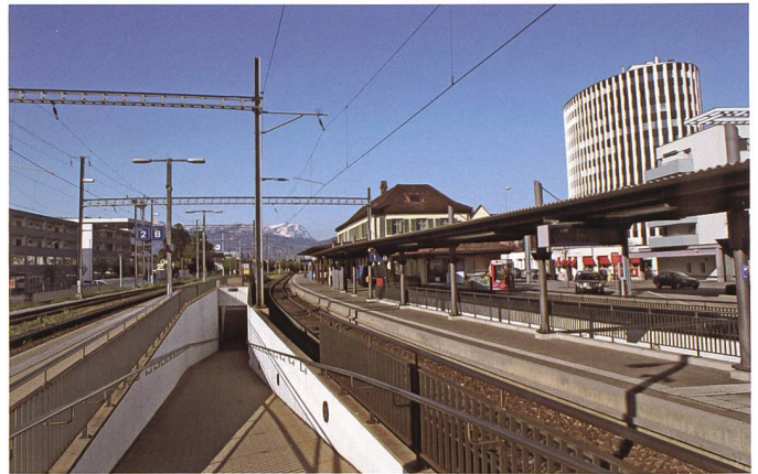
Heerbrugg im Frühjahr 2013. Die Perronkanten sind schienenfrei und behindertengerecht zugänglich, der Bushof liegt in komfortabler Nähe. Foto Anton Heer, 25. April 2013
