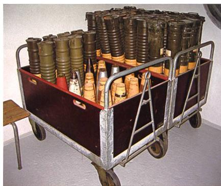
**Transportwagen im Munitionsvorbereitungsraum (Laborierraum) für den Transport der Granaten und Triebladungen (Büchsen) zur Basis der Munitionstransportanlage zum Panzerturm.**
