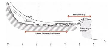
Abb. 21: Dieser Schnitt belegt die Verbreiterung der Strasse.
