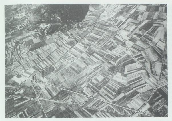
**Die Flugaufnahme** aus dem Jahr 1946 zeigt die Ebene beidseits der Strasse von Oberriet (links) nach Altstätten vor der Güterzusammenlegung mit den noch unzähligen alten Streifenparzellen. Erkennbar sind die **Drainagennetze** der damals laufenden Flächenentwässerung.
