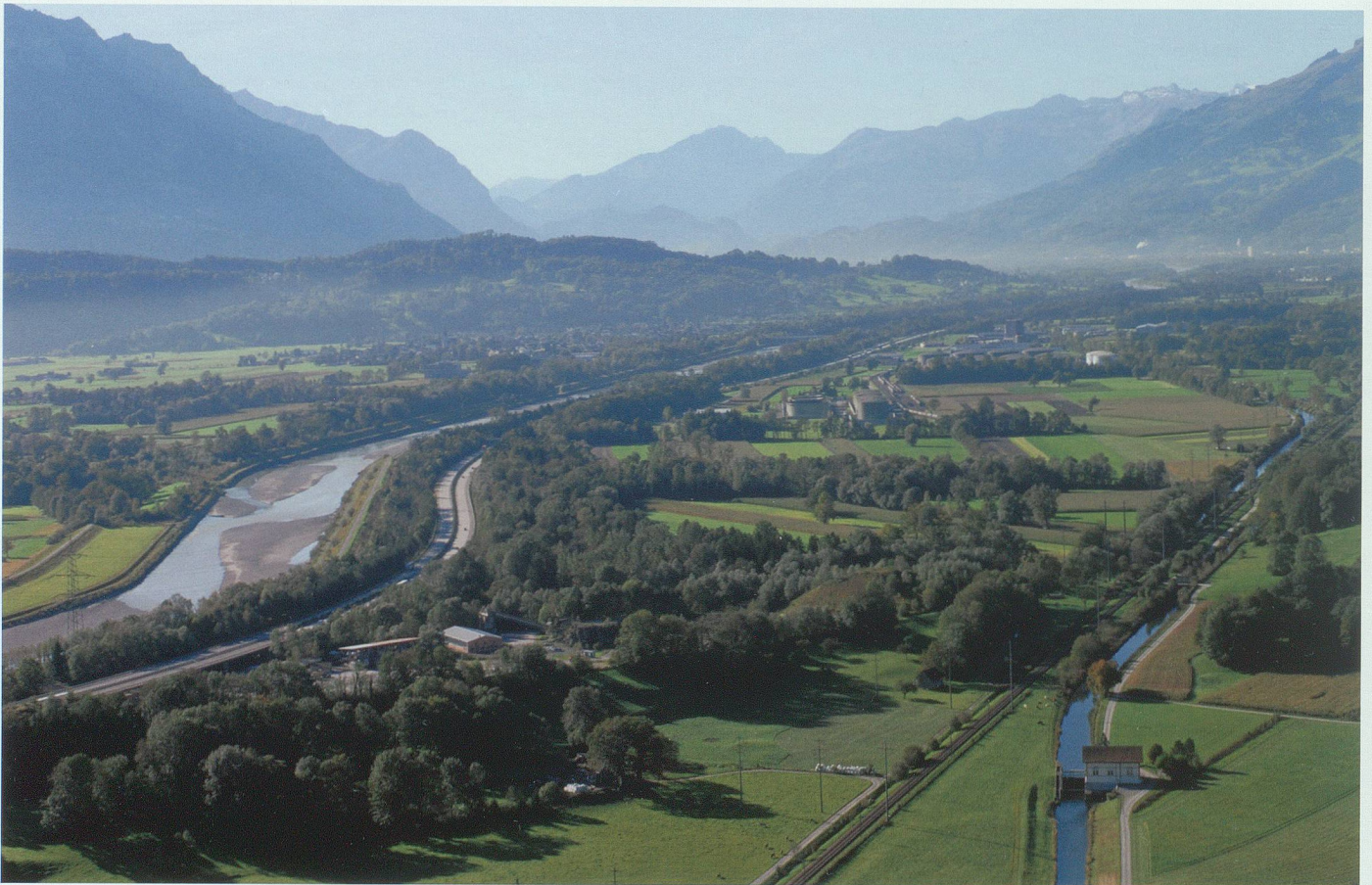
Jost Wey's Rheintaler Wirkungsfelder auf einen Blick, aufgenommen im Schluch bei Lienz: Links der korrigierte Alpenrhein (im Übergangsbereich vom Hochwuh- zum Doppelwuhrsystem), vorne rechts der Rheintaler Binnenkanal, darüber (links von der Eisenbahnlinie) der Werdenberger Binnenkanal. Luftaufnahme 2006, Hans Jakob Reich, Salez
