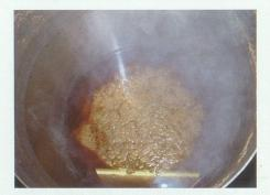
Nach dem Hopfenkochen wird die Würze in Rotation versetzt, wodurch sich die schweren Trubstoffe (Eiweiss und Hopfenrückstände) abtrennen lassen. Die klare Würze wird danach heruntergekühlt, in den Gärtank gegeben und mit Hefe ver-
