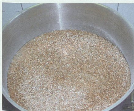
Beim Maischen wird Malzschrot mit Wasser verrührt und erwärmt, wodurch die Enzyme im Malz aktiviert werden, die einen grossen Teil der Stärke im Malzkorn in vergärbaren Zucker umwandeln.
