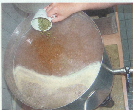
Beim Kochen der Würze wird Hopfen beigegeben, der dem Bier die Bitternote verleiht. Foto Sevibräu GmbH, Sevelen
