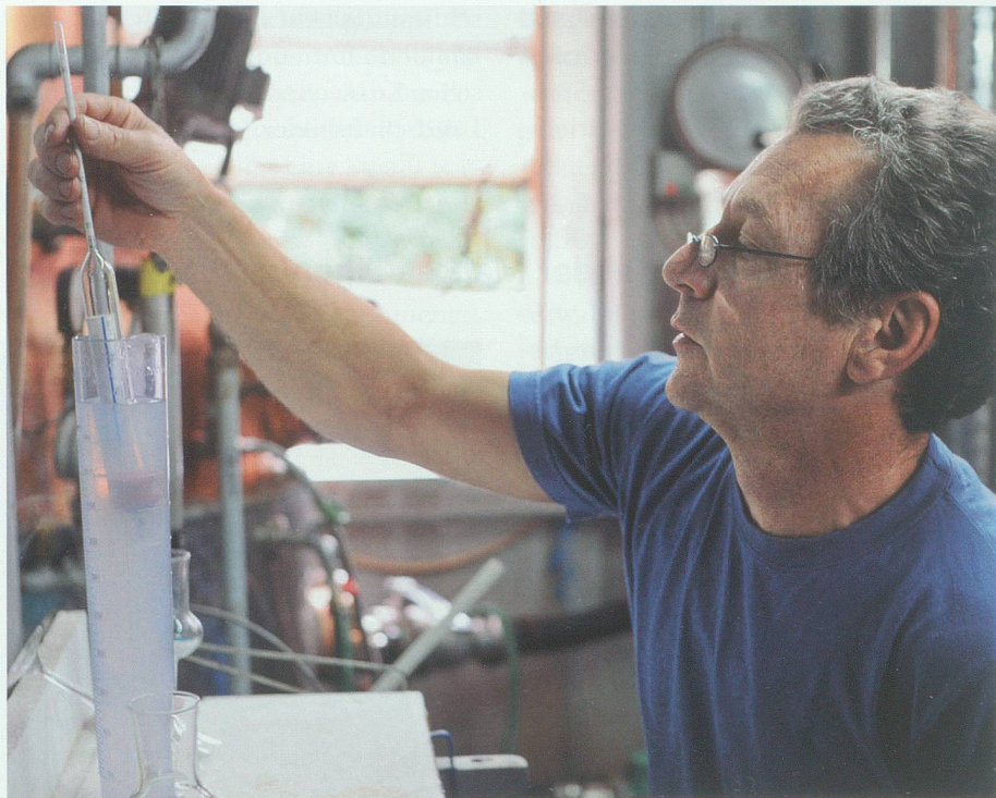
Mit entmineralisiertem Wasser stimmt der Gamser Brenner Martin Schegg das Destillat auf den gewünschten Alkoholgehalt ab. Foto Gian Ehrenzeller, Buchs
