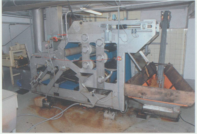
In der Mosterei Hans Heeb in Sax wird heute zum Pressen von vermahlenem Obst eine sogenannte Siebbandpresse verwendet.
