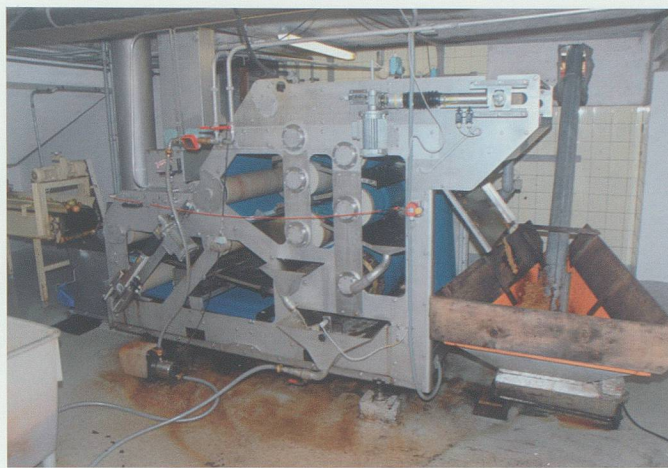
In der Mosterei Hans Heeb in Sax wird heute zum Pressen von vermahlenem Obst eine sogenannte Siebbandpresse verwendet.
