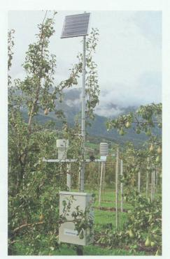
In der Wetterstation Grabs werden täglich die Wetterdaten erfasst. Sie werden an der Forschungsanstalt in Wädenswil ausgewertet. Auf diese Weise wird während der Kernobstblüte die Blüteninfektionsgefahr ermittelt.
