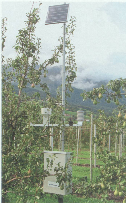
In der Wetterstation Grabs werden täglich die Wetterdaten erfasst. Sie werden an der Forschungsanstalt in Wädenswil ausgewertet. Auf diese Weise wird während der Kernobstblüte die Blüteninfektionsgefahr ermittelt.
