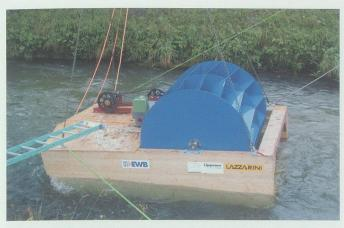
Der vom EWB entworfene Prototyp eines schwimmenden Flusskraftwerks. Foto EWB
