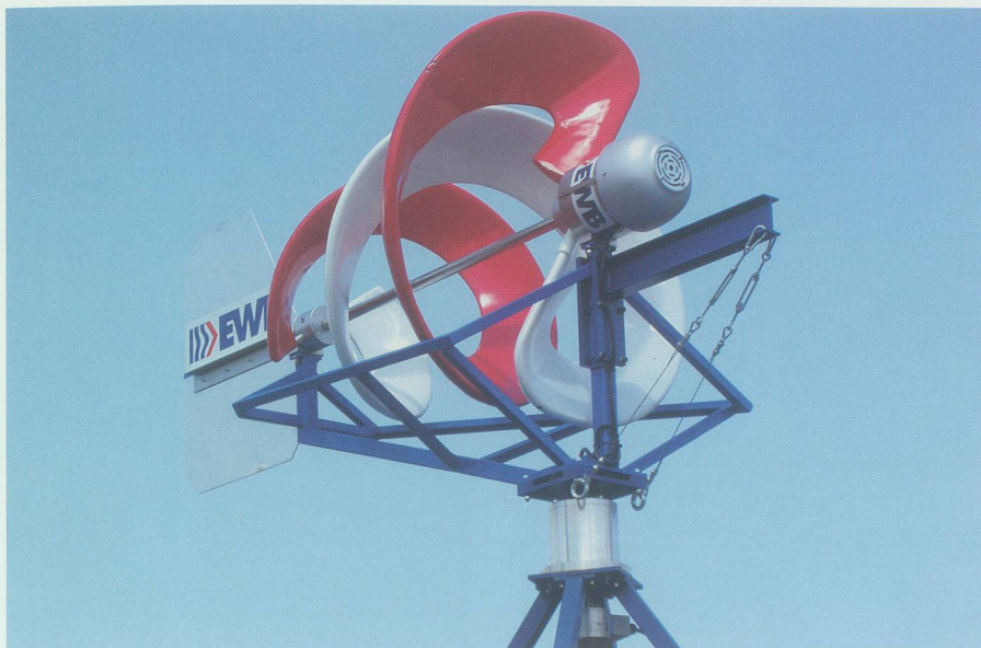
Innovatives, föhntaugliches «Windrad» für den dezentralen Einsatz: der «OekoSpin» des Wasser- und Elektrizitätswerks Buchs. Foto EWB
