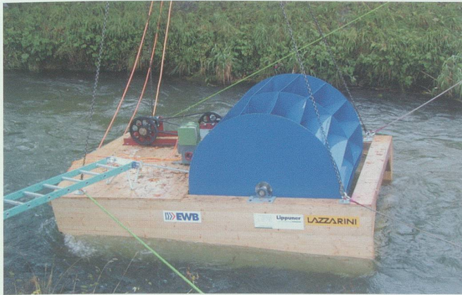
Der vom EWB entworfene Prototyp eines schwimmenden Flusskraftwerks. Foto EWB
