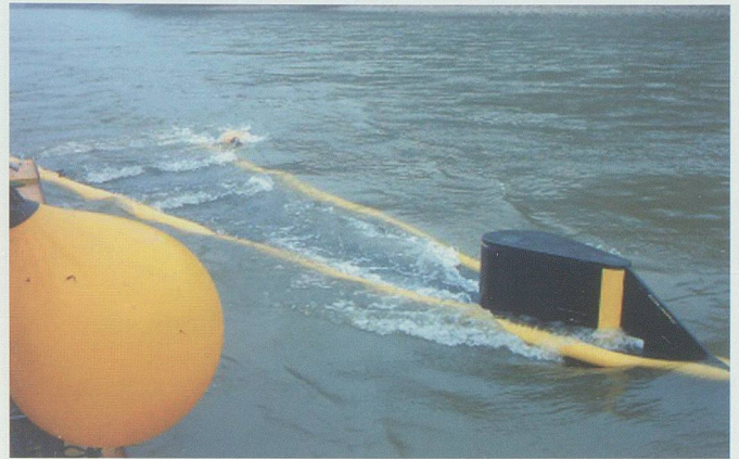
Die in Österreich entwickelte Stromboje ist grösstenteils im Wasser «versteckt». Aqua Libre Energieentwicklung GmbH
