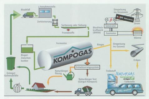
In einer Kompogasanlage kann aus Biomasse Gas und Elektrizität gewonnen werden. Darstellung Kompogas AG
