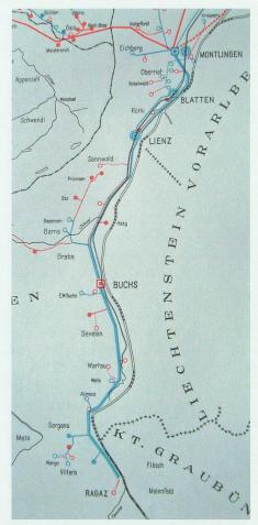
Rot: Zuwachs der Hochspannungs-Verteilanlagen im Rheintal/Werdenberg bis zum Jahr 1939. Blau: Durch die SAK 1914 vom Kantonswerk übernommener Bestand. Elser 1940, bei S. 116
