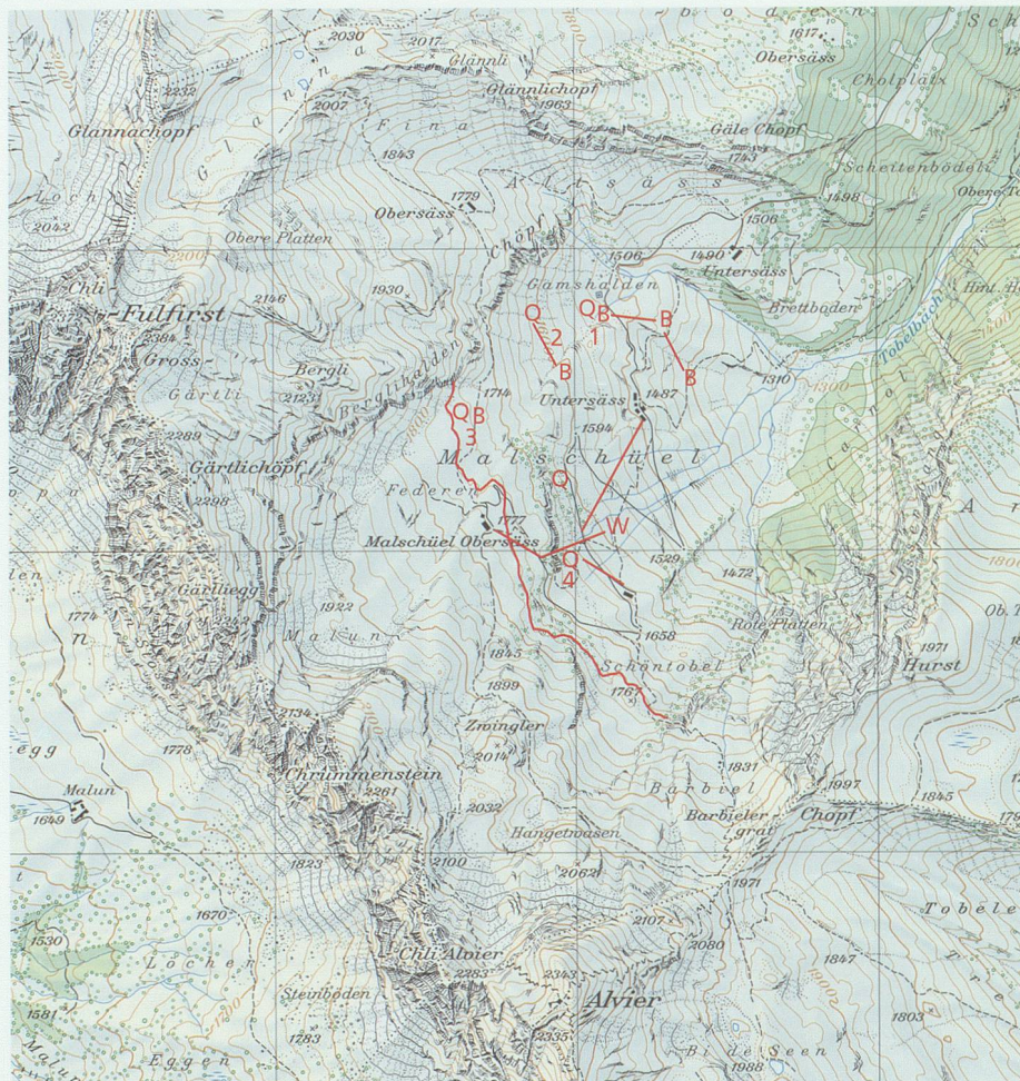
Quellen und Brunnen in Imalschüel: 1 Gamsquellen, Brunnen auf Gams und Leitungsstrang zu den Brunnen bei der alten Hütte und beim Brentenplatz; 2 Mooseschliquelle und -brunnen; 3 Federenquellen und -brunnen; 4 Widderquellen mit Fassung und Leitungsnetz zum Widder (W) und zum Ober-, Mittel- und Undersäss. Die rote Linie markiert die Höhenquote 1750 m ü. M., die Obergrenze der Quellaustritte. Reproduziert mit Bewilligung von swisstopo (BA081630)
