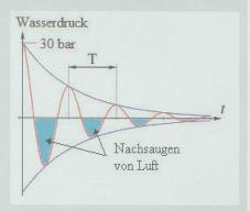
Druckschwingungen im Treibrohr eines Widders.
