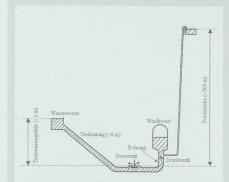
Rohrplan eines hydraulischen Widders.
