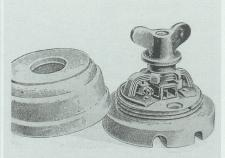
Schalter für Innenanlagen, um 1900, links mit Zungenkontakten, rechts mit Bürstenkontakten. Die Platten und Deckel waren aus Porzellan. Die Schalter konnten in beliebiger Richtung gedreht werden. Wyssling 1946
