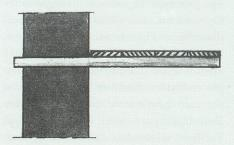
Abb. 13a: Fliegendes Gerüst. Dicke Hölzer wurden quer über die Mauer gelegt. Darüber wurde weitergebaut. Sobald die Hölzer tragfähig waren, konnten auf der Innen- und Aussenseite der Mauer Gerüstbretter auf die Hölzer gelegt werden.
