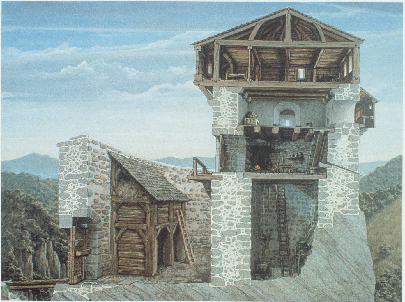
Abb. 19: Den Eingang zum Wohnturm erreichte man über eine Treppe, die meist in den Küchenraum führte. Darüber lag eine beheizbare Stube. Der Obergaden diente als Schlafgelegenheit und Sommeraufenthalt. Im Keller lagerten Vorräte. Der Turm war in der Regel von einer Ringmauer umgeben, die einfache Wirtschaftsbauten mit einschloss.
