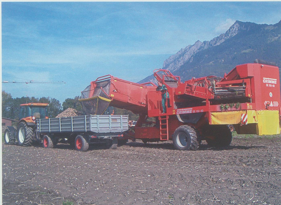
Von der zweireihigen Erntemaschine werden die Kartoffeln direkt in einen Kipper umgeladen. Foto Peter Zogg, Weite
