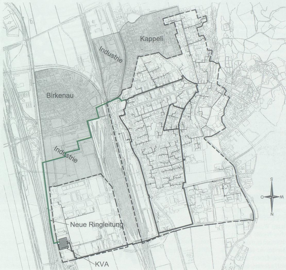
Die neue Ringleitung (zweites Standbein) wird in den nächsten Jahren realisiert und ermöglicht die erweiterte Fernwärmespeisung der Gebiete Birkenau, Kappeli und die angrenzenden Gewerbezonen.
