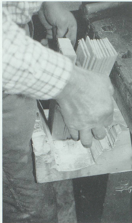
Aus jeder Mösele werden 20 bis 30 Schindeln geschnitten.
