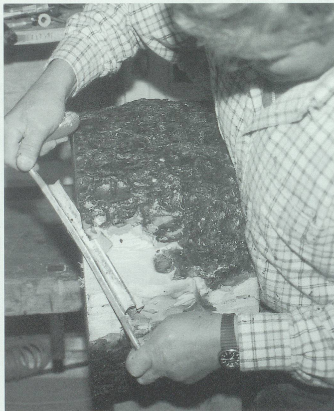
Mit dem Schälmesser wird die Rinde abgezogen.
