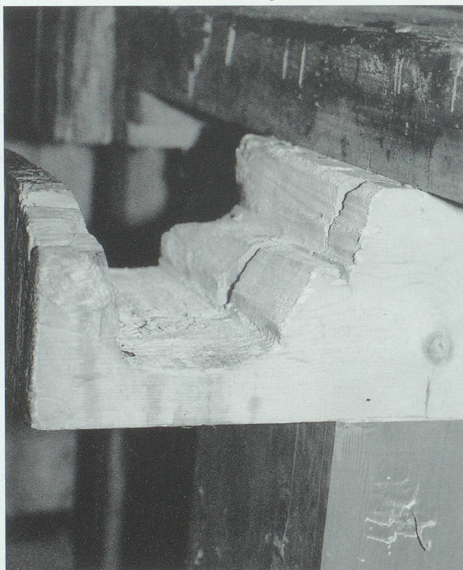
Im Schindelbock wird der Rohling bearbeitet.
