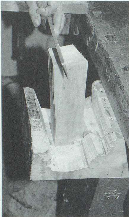
Beim Beizen wird die Mösele je nach gewünschter Schindeldicke angeschlagen.
