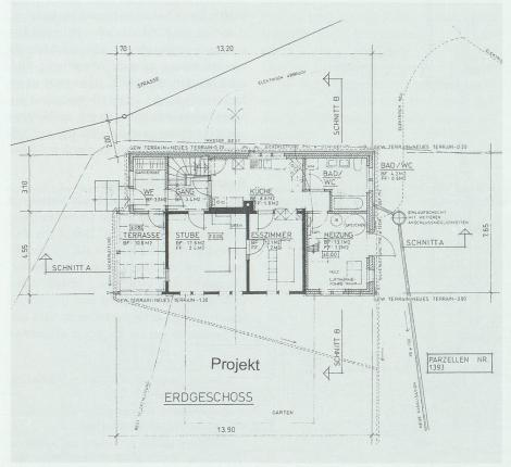
Die Plandarstellung der Grundrisse Erdgeschoss in der Aufnahme und im Projekt zeigt, dass die statische Grundstruktur und die Nutzungszuweisung der Räume grundsätzlich unverändert bleiben.
