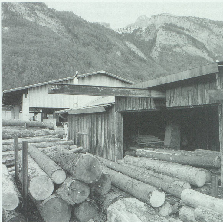
Eine der letzten als Vollerwerb betriebenen Werdenberger Sägereien ist die Sägerei Friedrich Göldi in Sennwald. Im Bild links das Vollgattersägewerk, rechts die Zuführung der Stämme auf die Säge. Bilder: Hans Jakob Reich, Salez.
