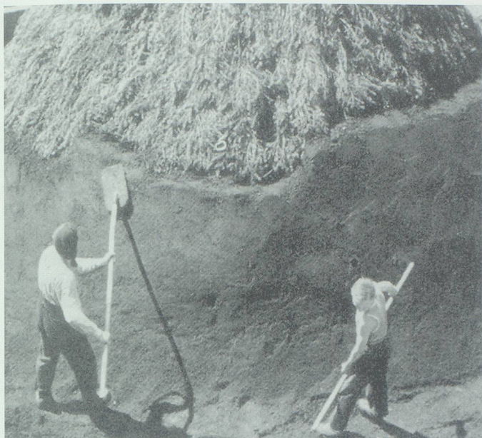
Über dem Mantel aus Tannenreisig wird die angefeuchtete Löschi aufgetragen. Aus Gall 1/2003.
