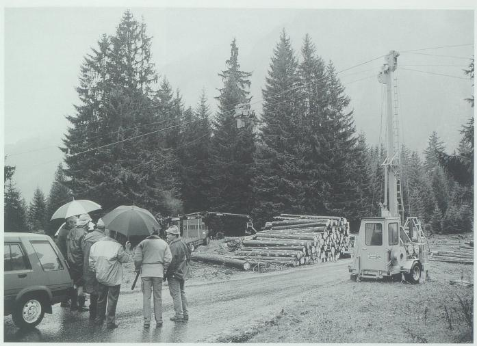
Einsatz eines Mobilseilkrans für die Holzbringung nach dem Sturm «Vivian» von 1990. Bild im Archiv des Kreisforstamtes Werdenberg.
