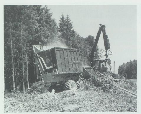
Ein zunehmender Anteil des Brennholzes wird heute – wie hier mittels Forwarder mit Aufbauhacker – direkt auf der Schlagfläche zu Holzhackschnitzeln verarbeitet.
